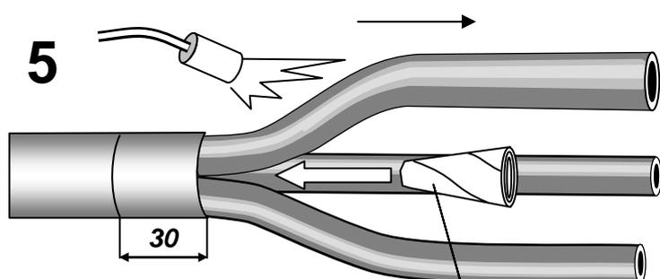
Надеть на каждую жилу трубку (ТТИ) до упора в «корешок» разделки кабеля. Усадить каждую трубку, начиная с «корешка» в направлении конца жилы. Убедиться, что трубки усажены равномерно и не имеют карманов воздуха или масла.
