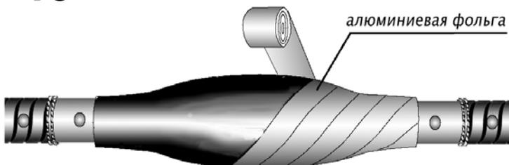
Поверх усаженной трубки произвести подмотку алюминиевой лентой с 20 мм перекрытием и заходом на 20 мм на оголенную оболочку кабеля с обеих сторон. Произвести разглаживание рукой лент экрана для плотного их прилегания к поверхности муфт.
