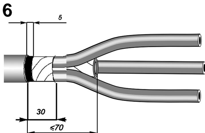
Снять поясok металлической оболочки (30 мм). На полупроводящий слой бумаги поясной изоляции на расстоянии 5 мм от оболочки наложить бандаж из льняной нити. Удалить полупроводящий слой от края поясной изоляции до бандажа. Бандаж удалить.
