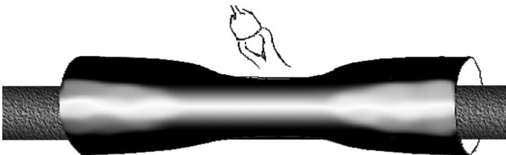
Надвинуть трубку-кожух (ТТШ) на муфту. Установить по центру. Усадить трубку, начиная с середины, равномерно разогревая её в одну и другую сторону по направлению краёв.
