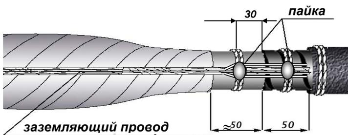
Распутить конец заземляющего провода на длине не менее 100 мм и закрепить его бандажами из 2-х-3-х витков проволоки на облуженных поверхностях. Произвести пайку заземляющего провода к бронелентам и оболочке с обеих сторон муфты. Пайку к оболочке производить на длине не менее 40 мм так, чтобы место пайки образовало гладкую выпуклую поверхность, а сам провод заземления, пропитанный припоем, не являлся бы каналом для проникновения влаги.
