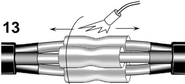
Надвинуть на каждую экранированную гильзу трубку (ТТИ-Д) для изолирования гильзы. Установить трубки по центру гильз. Усадить трубки, начиная с середины.
