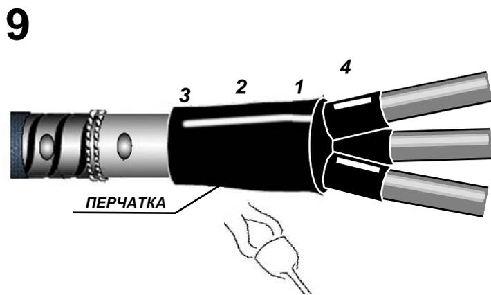
Надеть на конец разделанного кабеля перчатку с усилием до упора в изолированный «корешок» разделки кабеля. Усадить перчатку в последовательности, указанной на рисунке. После усадки на торцах пальцев перчатки должен быть виден клей-расплав.
