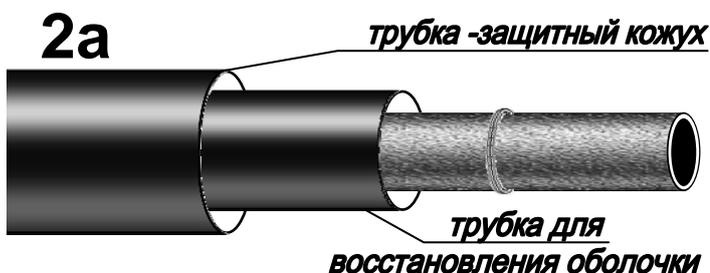
Надвинуть на конец одного из соединяемых кабелей полиэтиленовый пакет от упаковки трубок для предотвращения возможности загрязнения внутренней поверхности используемых трубок. Поверх полиэтиленового пакета надеть трубки для восстановления оболочки и защитный кожух, сдвинуть их на время монтажа вдоль кабеля за бандаж или кольцевой надрез по шлангу.
