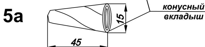
Из ленты герметика «конусный вкладыш» (из комплекта манжет на «корешок») сделать конус и тщательно затолкать его в «корешок» разделки кабеля (после уплотнения расстояние от края герметика до среза оболочки не должно превышать 70мм).
