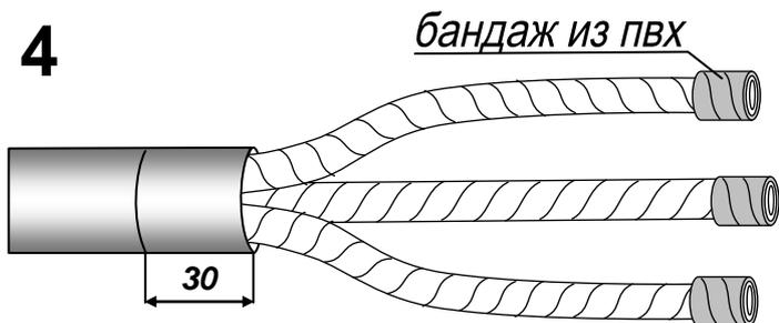
Закрепить концы фазной изоляции кабеля бандажом из ленты ПВХ (липкой) клеящей стороной наружу. Допускается снятие расцветочных лент по фазной изоляции кабеля. Развести жилы каждого из соединяемых кабелей по шаблону или через палец. Радиус изгиба – не менее 10 – кратной высоты сектора или диаметра жилы по изоляции.
