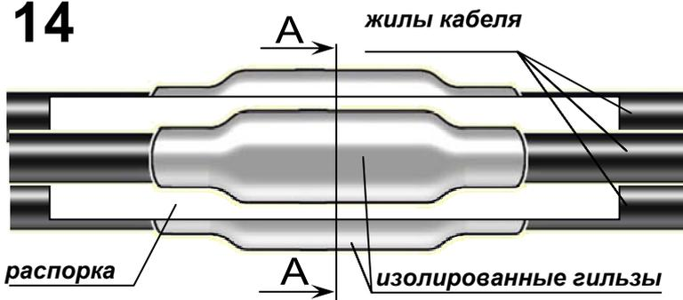
Раздвинуть жилы между собой на небольшой угол так, чтобы между ними вошла распорка. Вставить распорку симметрично относительно центра муфты.
