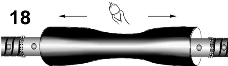
Надвинуть трубку для восстановления оболочки, разместить симметрично относительно центра муфты и усадить, начиная с середины. Усадку производить, равномерно разогревая трубку в одну и другую сторону.
