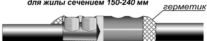
Ввести зачищенные концы жил в гильзы. Гильзы повернуть так, чтобы винты прижимали радиусные поверхности жил. Не допускается прижимание жил на ребро. Плавно, без резких движений, затянуть винты до срыва головок, в последовательности, указанной на рисунке, придерживая гильзу трубным ключом или специальным приспособлением. Острые выступы от среза винтов удалить напильником так, чтобы выступы не превышали над поверхностью гильз 1 мм.
