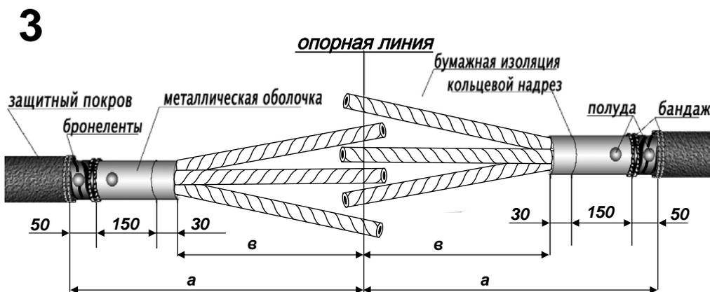
Удалить защитный покров кабеля и бронелент в соответствии с указанными размерами. Облудить бронеленты и алюминиевую оболочку кабеля, а свинцовую оболочку – зачистить. Произвести дальнейшую разделку, как указано на рисунке.
