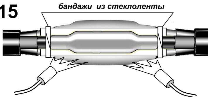
Сжать жилы вместе, расположив их треугольником как можно ближе друг к другу. В сжатом состоянии в местах окончания трубок для изолирования гильз, наложить бандажи из стеклоленты, сложенной вдвое. Прогреть горелкой концы распорки до начала оплавления ребер (зона прогрева составляет 70 – 100 мм).
