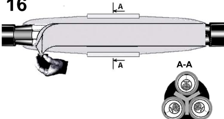
Снять бумагу с заполнителей (3шт) и вставить их между соседними жилами так, чтобы плоская большая сторона заполнителя была обращена наружу. Затолкать каждый заполнитель в пространство между жилами и распоркой и между «пальцами», предварительно нагрев его горелкой. Пальцами придать заполнителю цилиндрическую гладкую форму по всей длине муфты
