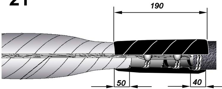
Обезжирить ступени оболочки и бронелент (с припаяным заземляющим проводом) с обеих сторон от муфты. Обмотать лентой герметика «С» с 30%-ным перекрытием без натяжения места паяк провода заземления с заходом на 40 мм на защитный покров с одной стороны и на 50 мм на алюминиевую фольгу-экран. Место между обрезом бронелент и краем экрана (алюминиевой фольги) вымотать в несколько слоев до выравнивания по высоте бронелент.
