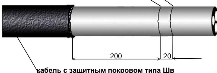
Удалить бронеленты с конца кабеля до бандажа (рис.1.3а), шланг до кольцевого надреза (рис.1.3). Очистить ветошью, смоченной бензином, бронеленты на длине не менее 50 мм, оболочку на длине не менее 250 мм от бандажа или среза шланга в сторону конца кабеля. На расстоянии 200 мм от среза бронелент или шланга выполнить на оболочке кольцевой надрез на половину толщины оболочки и на расстоянии 20 мм от нее – второй кольцевой надрез.
